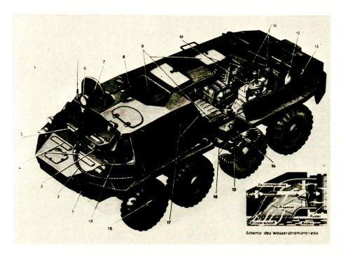
I Wellenabweiser; 2 Schleppseil; 3 Platz des Kommandanten; 4 Lüftungsklappen; 5 Beobachtungsluken mit Triplexblöcken; 6 Infrarotscheinwerfer; 7 Einstiegsluke des Kommandanten; 8 schweres Maschinengewehr; 9 Luken und Sitze der motorisierten Schützen; 10 Motoren; 11 Kühler; 12 Treibstoff behälter; 13 Auspuffanlage; 14 hydraulische Stoßdämpfer; 15 Bremszylinder; 16 Aufhängung; 17 Schießluken der motorisierten Schützen; 18 Radabsperrventil; 19 Fahrersitz.
