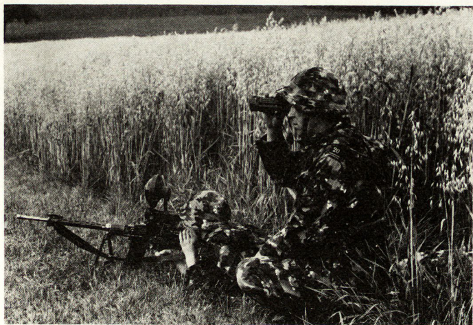
Bild 6. Infrarotfeldstecher zur Überwachung eigener oder fremder Infrarottätigkeiten.
