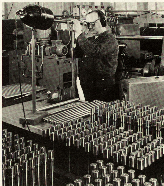
Kontrolle der Läufe (Zug- und Feldprofile) nach dem Hämmern
