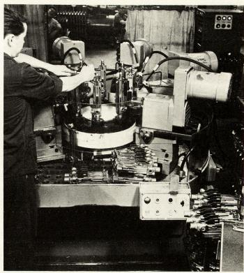
Die Verschlußkopflager im Verschlußgehäuse (Sturmgewehr 57) werden ausgebohrt.
