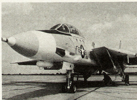
Bild 1. Schwenkflügelkampfflugzeug Grumman F-14A. Sichtbar ist unter anderem der Lufteinlauf mit verstellbarer Einlaufschneise für den Motor links.
