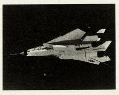
Bild 3. Der X-1 in Hochgeschwindigkeitskonfiguration, deren Tragwerk automatisch, entsprechend der Flugmachzahl bis zu einer Pfeilung von 60 Grad angelegt werden kann.
