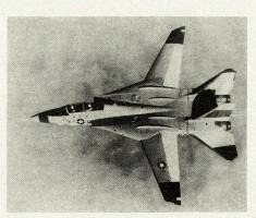
Bild 2. Der im Flug sichtbare Prototyp des F 14-A, X-1 der inzwischen bei der Flugerprobung verlorenging, mit Tragwerk für Startund Landekonfiguration voll gespreizt.
