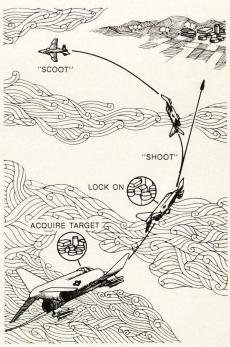
Bild 2. Angriffsverfahren der «Maverick» gegen ein Bodenziel. Der Pilot sieht das Ziel auf dem Fernsehschirm, erfaßt es im Fadenkreuz, löst die Lenkwaffe aus und kurvt mit Höchstfahrt tief weg.
