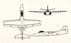
Erdkampfflugzeug A 9 A von Northrop: Einbau der Bordbewaffnung (hier im Bild 20-mm-Gatling) benötigt hinter und unter dem Cockpit sehr viel Platz. Vorgesehen ist eine 30-mm-Schnellfeuerkanone von General Electric oder Philco-Ford. Das große Trommelmagazin faßt 1350 Schuß.
