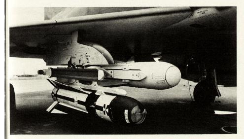
Die AGM 65A «Maverick» ist eine neue fernsehgesteuerte, raketengetriebene Luft/Boden-Lenkwaffe, die die Amerikaner mit der taktischen Luftwaffe einsetzen. Präzision und Wirkung im Ziel sind derart, daß diese Waffe gegen sogenannte harte Ziele, wie Schiffsziele, Bunker, Mannschaftstransportfahrzeuge, abgestellte Flugzeuge, Radarstationen und Flabstellungen, eingesetzt werden kann. Kg.
