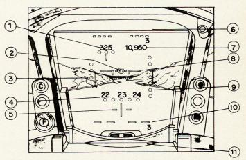
Figur 3. Head-up-Display-Symbole auf dem Blickfeldanzeige- und Zielgerät. 1 Anzeige für Fluggeschwindigkeit; 2 Flugzeugsymbol; 3 Anblasrichtungsanzeige; 4 Steuerkurs; 5 Schiebeflug; 6 Längsneigungswinkel positiv; 7 barometrische Höhe; 8 Horizont; 9 Vertikalgeschwindigkeitsanzeige; 10 Längsneigungswinkel negativ; 11 Projektionsoptik.
