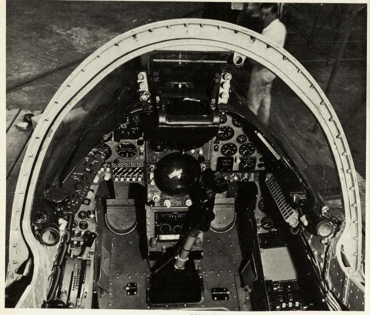
Bild 1. Blick ins Cockpit eines Erdkampfflugzeugs. Im Vordergrund (oben) das Blickfeldanzeigegerät (Head-up-Display), zugleich Zielgerät des Piloten mit der schräggestellten Scheibe. Mitte unten das Rollkartengerät NDC.
