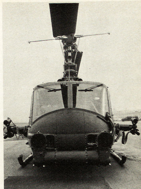
Bild 2. «Infant»-System, auf UH1 M-«Iroquois»-Helikopter montiert.
