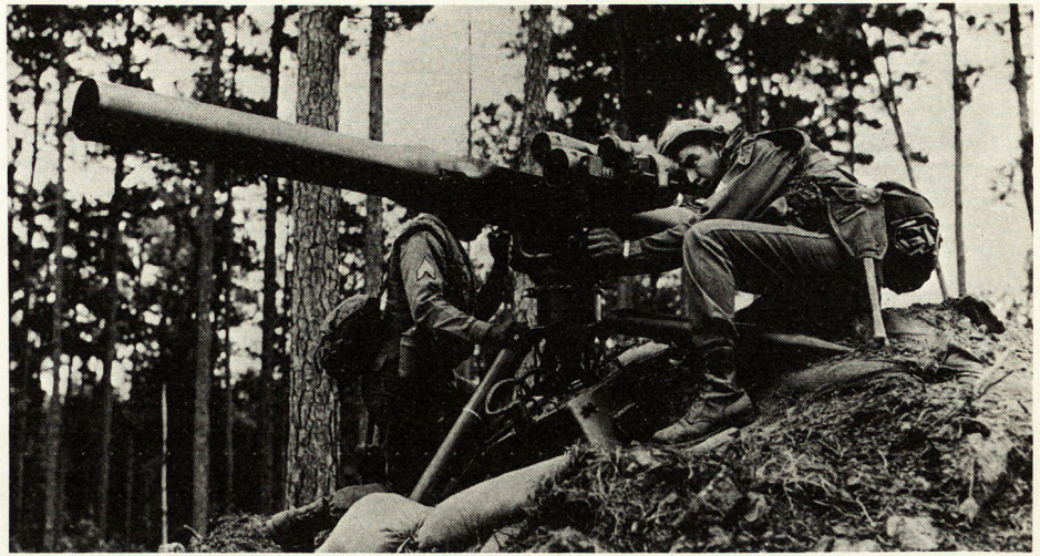
Bild 2. TOW-Lenkwanne, -Rohr und -Feldlafette.
