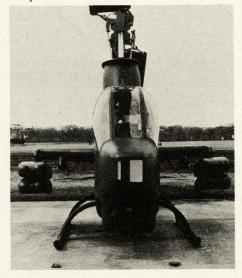
Dieser Kampfhelikopter wird mit Panzerabwehrlenkwaffen vom System TOW ausgerüstet. Die TOW gibt der Huey «Cobra» eine außerordentlich hohe Waffenwirkung gegen stark befestigte Ziele und gegen Panzerfahrzeuge auf Distanzen bis zu 3000 m. Die Lenkwaffen sind in Zweierbehältern an der äußeren Waffenstation des Flügelstummels aufgehängt. Das Bild zeigt eine Maquette dieses Helikopters mit je vier Lenkwaffen pro Seite.
