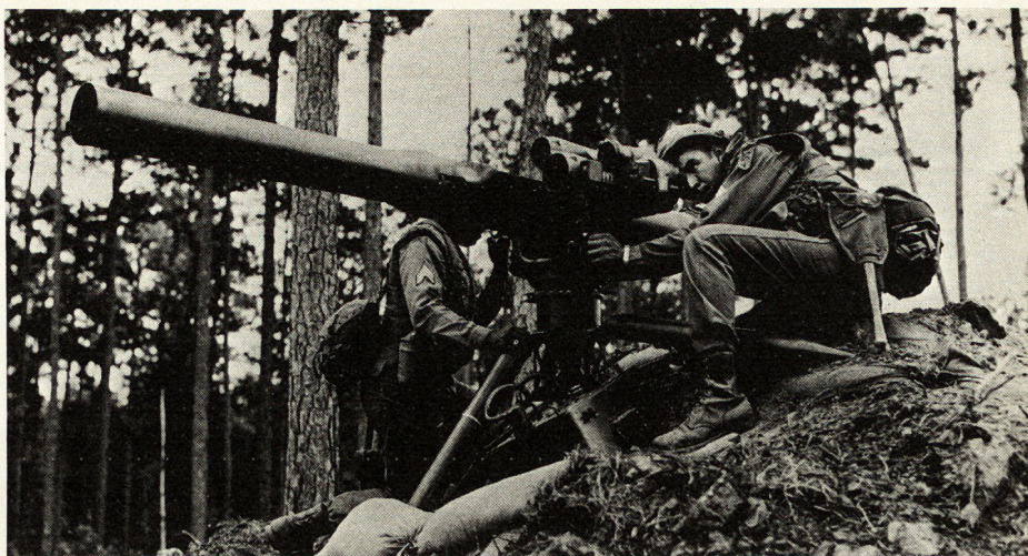
Bild 2. TOW-Lenkwaffe, -Rohr und -Feldlafette.
