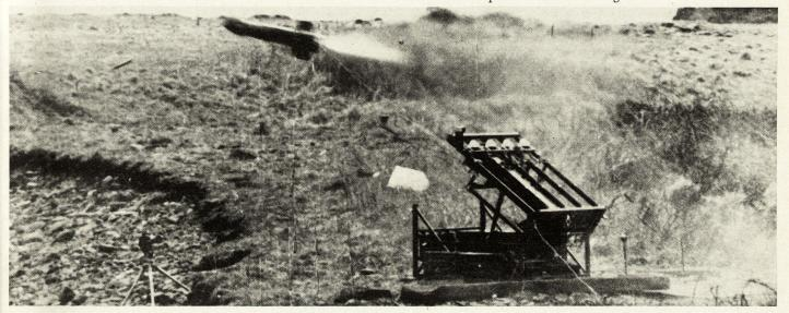
wenn Sucher und Abschußvorrichtung auf einem Geschützturm montiert sind); dann kann in jeder Richtung geschossen werden. Es versteht sich von selbst, daß sowohl relative Position als auch Niveau der Abschußvorrichtung und des Suchers genau übereinstimmen müssen, wenn das «Gathering»-System zuverlässig arbeiten soll. Wenn die Fernlenkwaffe dauernd auf einem Fahrzeug montiert ist, müssen diese Relativstellungen periodisch überprüft werden.
