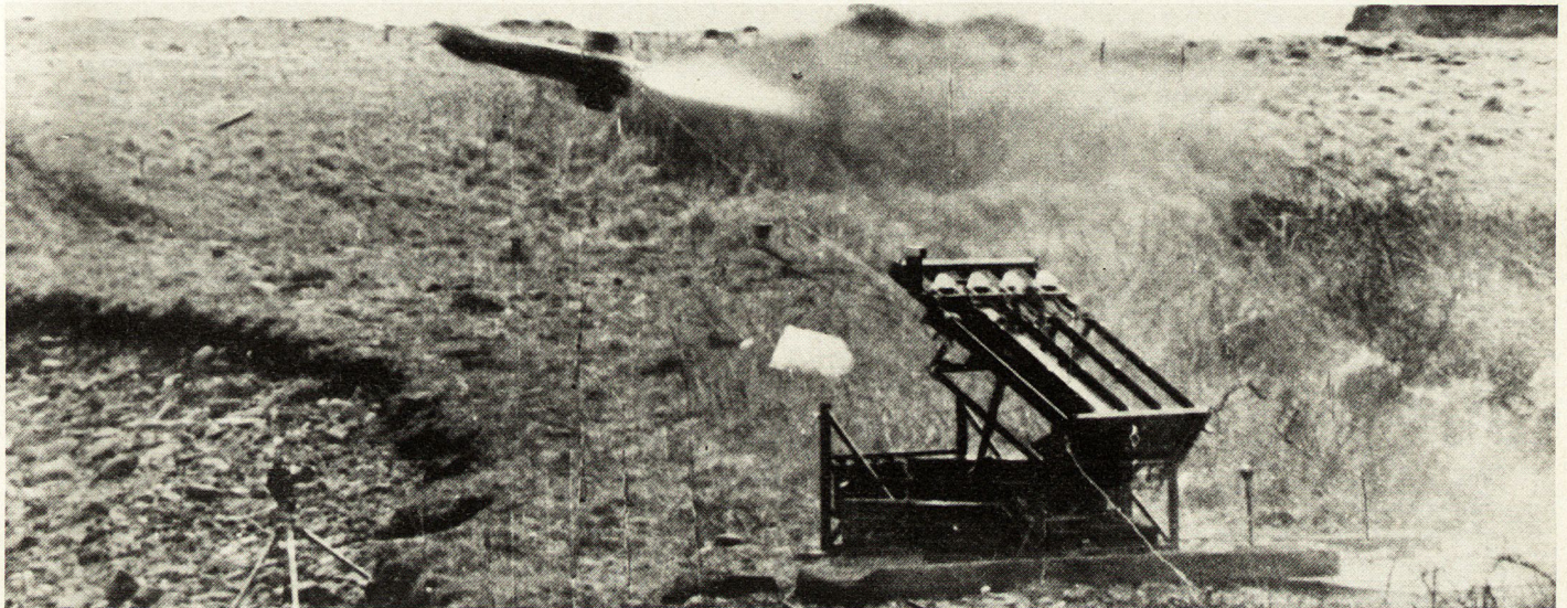
Bild 2. Eine «Swingfire»-Fernlenkwaffe beschleunigt in Richtung Ziel. Dieser Abschub fand auf einem aus der Luft abwerfbareren Abschubgerät mittels einer «Separator»-Zielvorrichtung statt.
