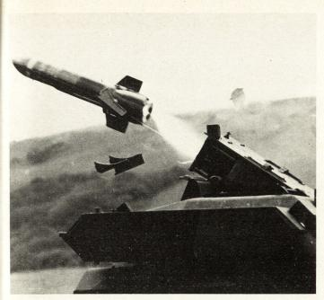
Bild 1. Abschuß einer «Swingfire»-Fernlenkwaffe. Links hat sich das Lenkwaffengeschoß unter einem charakteristisch steilen Winkel aus dem Behälter gelöst; Teile der Verschalung fallen weg.
