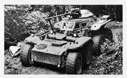
kann auf Schnee fahren, wo sich vorher nur Spezialfahrzeuge bewegen konnten. Geplant ist eine leichte Familie von 8 bis 9 t, vornehmlich als Spähpanzer, sowie eine mittlere Familie von 15 bis 18 t, als Schützen-, Jagd- und Flabpanzer. Die Prototypen der zweiten Generation wurden im Januar 1970 den Heereserprobungsstellen übergeben. Spätere Umgestaltung zu voller Schwimmfähigkeit mit Wasserstrahlantrieb ist geplant.
