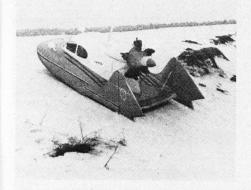
260-PS-Fünfzylinder-Flugzeugsternmotor. Die Lenkung erfolgt mit Hilfe zweier Seitenruder. Dieses Fahrzeug kann fünf Passagiere oder eine Nutzlast von 650 kg transportieren. Im Schnee entwickelt es eine maximale Geschwindigkeit von mehr als 120 km/h.
