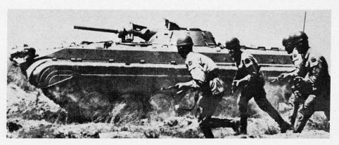
der Bordwand herausfeuern. Die Schützen besitzen das Sturmgewehr AK47 mit Klappkolben. Im randlosen Helm befinden sich in den Seitenklappen Kopfhörer. Der Schützenpanzer hat eine 7,62-mm-Kanone und die Panzerabwehrlenkwaffe «Sagger», welche bis etwa 2000 m wirken kann.
