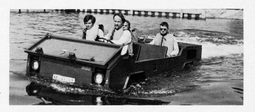
Brennstoff behälter und Bremshydraulik. Deformationskörper hinten und vorn erhöhen die Sicherheit bei Auffahrunfällen. Länge 3912 mm, Breite 1840 mm, Bodenfreiheit 280 mm, Leergewicht 1600 kg, Nutzlast 500 kg Kilo, Höchstgeschwindigkeit des 95-PS-BMW-Motors 105 km/h, Steigfähigkeit bis 60% (4 km/h), Reichweite 800 km. bb («Soldat und Technik» Nr. 6/1971)
