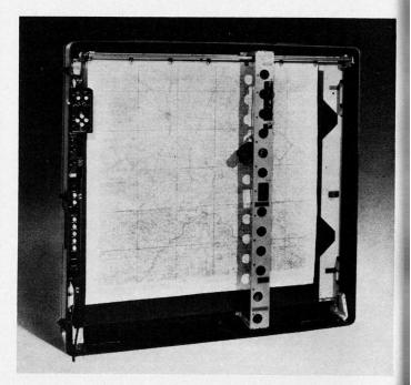
Bild 4. Die computergesteuerte Zeichenmaschine.
