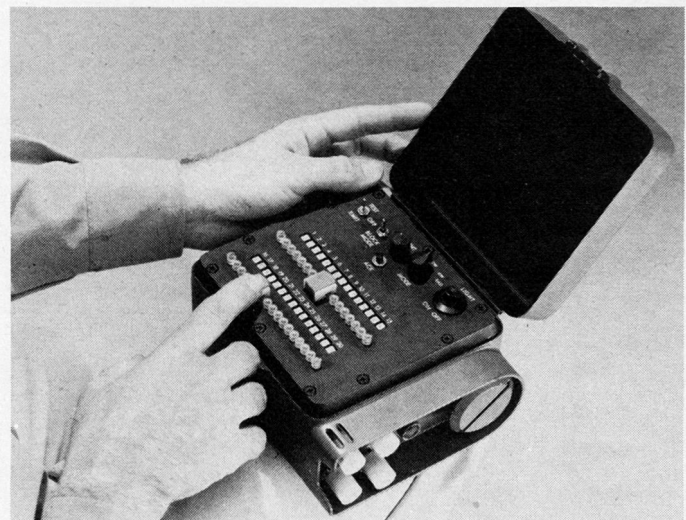
Bild 8. Das Eingabegerät des Schießkommandanten.
