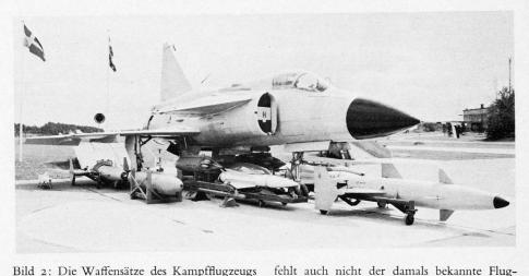
Bild 2: Die Waffensätze des Kampfflugzeugs AJ 37 Viggen: Von links nach rechts sehen wir: RB28-Luft/Luft-Lenkwaffe, RB04-anti-U-B00t-Lenkwaffe, Sidewinder-Lenkwaffe, 13,5cm-Rak-Werfer, 30-mm-Kanonen, RB05 A-Luft/Boden-Lenkwaffe, sowie eine weitere RB28-Lenkwaffe.
