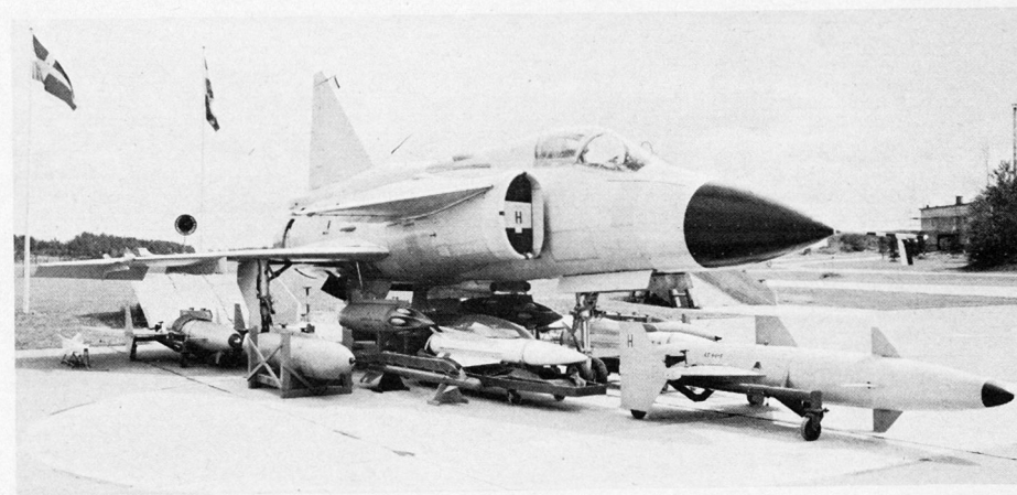
Bild 2: Die Waffensätze des Kampfflugzeugs AJ 37 Viggen: Von links nach rechts sehen wir: RB 28-Luft/Luft-Lenkwanne, RB 04-anti-U-Boot-Lenkwanne, Sidewinder-Lenkwanne, 13,5-cm-Raketenwerfer, 30-mm-Kanonen, RB 05 A-Luft/Boden-Lenkwanne, sowie eine weitere RB 28-Lenkwanne.
