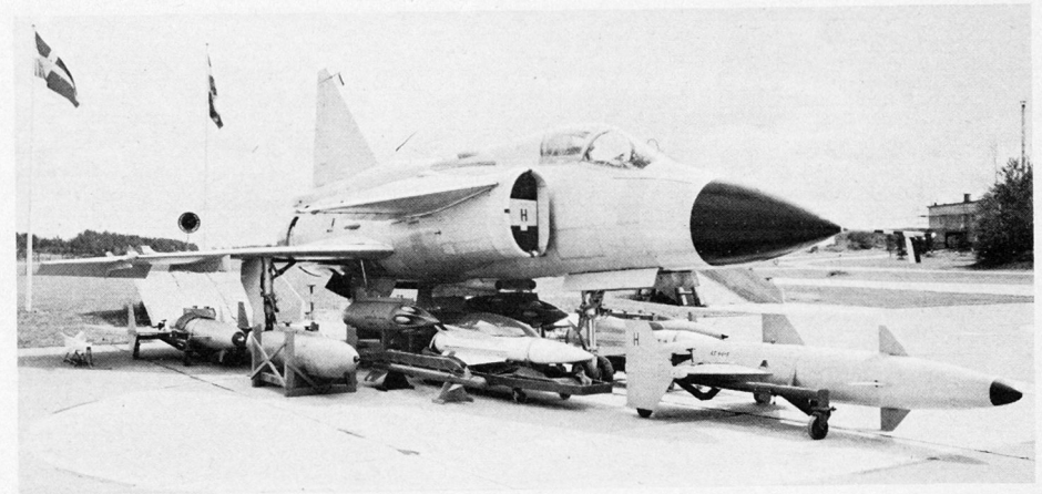
Bild 2: Die Waffensätze des Kampfflugzeugs AJ 37 Viggen: Von links nach rechts sehen wir: RB 28-Luft/Luft-Lenkmaschine, RB 04-anti-U-Boot-Lenkmaschine, Sidewinder-Lenkmaschine, 13,5-cm-Rak-Werfer, 30-mm-Kanonen, RB 05 A-Luft/Boden-Lenkmaschine, sowie eine weitere RB 28-Lenkmaschine.
