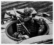
Bild 3. Minenwerfer-Schützenpanzer FV 432 mit 81-mm-Werfer.
