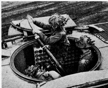
Bild 3. Minenwerfer-Schützenpanzer FV 432 mit 81-mm-Werfer.
