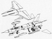
Das Flugzeug soll durch zwei Nachbrennertriebwerke General Electric J97 von je etwa 10000 Pfund Schub angetrieben werden. Der P530 erreicht damit eine Höchstgeschwindigkeit in großer Höhe entsprechend Mach 2. Ohne Außenlasten und mit vollem internem Brennstoff soll eine Steiggeschwindigkeit von 350 m/sec erreicht werden; die Einsatzgipfelhöhe dürfte bei etwa 18,5 km liegen. Die Manövrierfähigkeit soll um 35 % höher liegen als bei derzeit eingesetzten US-Jagdflugzeugen.
