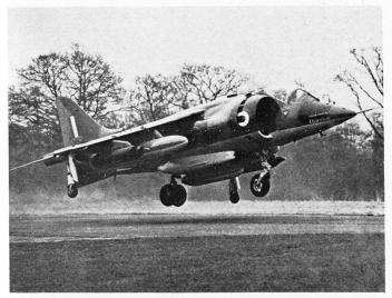
Bild 6. Senkrechtstarter Hawker Siddeley «Harrier».
