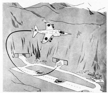
Bild 7. Startmöglichkeit für den «Harrier» trotz zerbombter Rollbahn.
