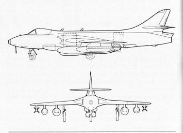
Bild 1. Der «Super Hunter» mit voller Zuladung. Neu sind die Rumpfrecks für  $2 \times 450$  kg Bomben.
