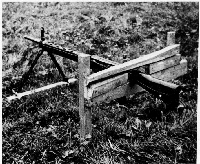
Bild 3. Ein Beispiel unter vielen Möglichkeiten für die behelfsmäßige Lafettierung eines Sturmgewehrs. Solche Vorrichtungen muß man in der Ausbildung bei Tage im scharfen Schuß – ohne Zielen – erproben, um eine zweckmäßige Form zu finden.
