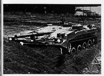
Bild 3. KPz Strv 103 mit Räumschaufel beim Eingraben.
