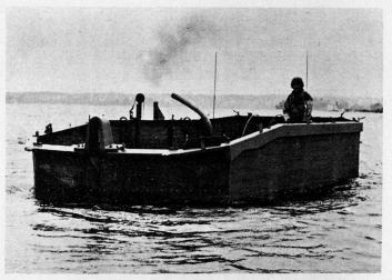
Bild 4. KPz Strv 103 beim Durchschwimmen eines Fjords.
