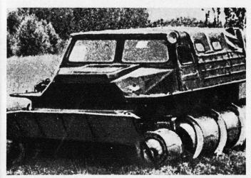
Bild 1. Schraubenfahrzeug LFM-RVD-GPI66 in versumpftem Gelände. Bild 2. Rotorschraubentransporter ShN 1.
