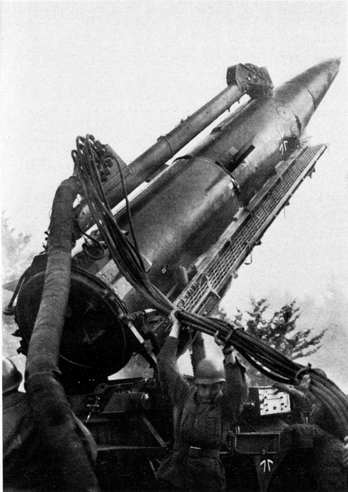
Bild 7. Die taktische Boden/Boden-Rakete MGM 31A «Pershing» geht in Stellung. Es handelt sich um eine Zweistufen-Feststoffrakete mit einem Startgewicht von 13,6 t, einer Reichweite von 600 bis 800 km. V_{max} = 4800 km/h mit Trägheitslenkung. Länge: 10,54 m, Durchmesser: 990 mm. Die deutsche Luftwaffe besitzt 2 Geschwader von dieser Waffe, die der NATO unterstellt sind. Die «Pershing»-Batterie verfügt über eine Abschubrampe mit 4 Einzelfahrzeugen: Raketenträger mit Aufrichtvorrichtung, Transportfahrzeug für die zweite Stufe mit Gefechtskopf, Feuerleit- und Prüffahrzeug, Fernmeldefahrzeug. Das Ganze basiert als Einheitsfahrzeug auf dem MTW M 113.
