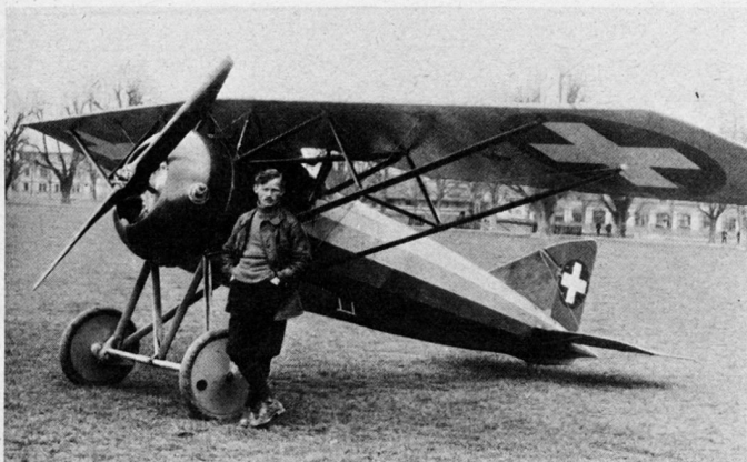
Bild 1. Wm Progin mit seinem «Morane-Saulnier MS. 29 C. 1», Baujahr 1918, 160-PS-Gnôme-Monosoupape-9 -Rotationsmotor, Maximalgeschwindigkeit 208 km/h.
