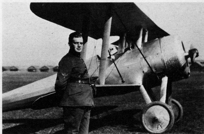
Bild 2. Hptm Robert Ackermann, Flugzeug Nieuport «Bébé 28 C. 1», Baujahr 1918, 160/170-PS-Gnôme-Monosoupape-9 N-Rotationsmotor, Maximalgeschwindigkeit 196 km/h.
