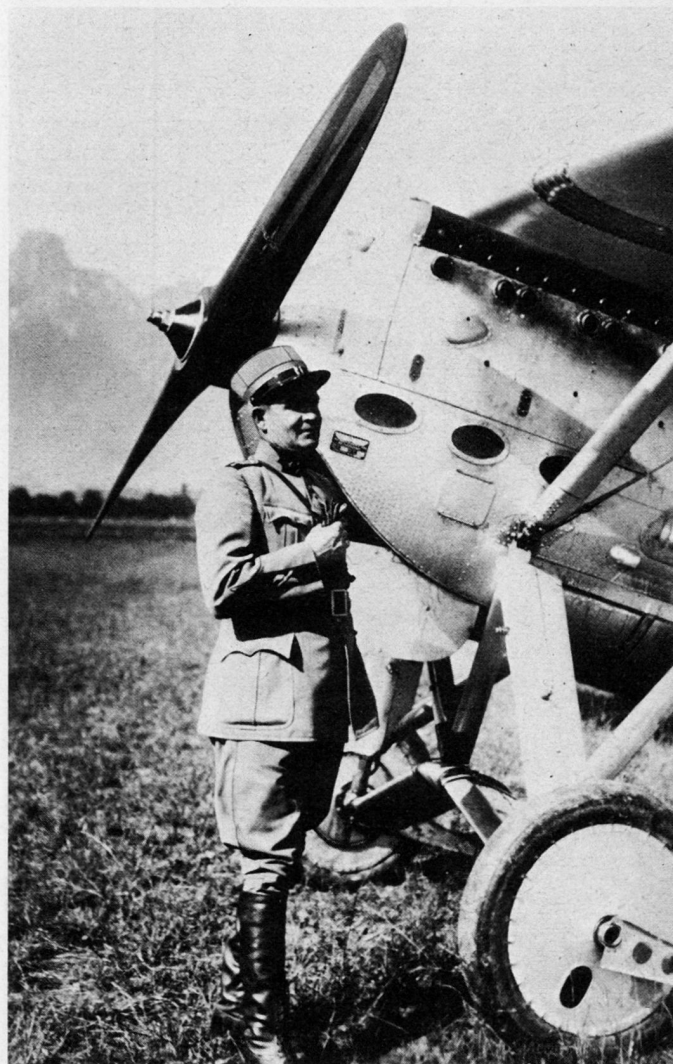
Bild 3. Hptm Adolf Schaefer, Flugzeug D 27, Baujahr 1928, 500-PS- H.S.-Motor, Lizenz Saurer/LFW, Maximalgeschwindigkeit 300 km/h.
