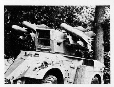
Bild 1. Panzer- und Tieffliegerabwehrlenkwaffe «Harpon» auf einem Fahrgestell AML Panhard mit einem NA 2-Drehturm.
