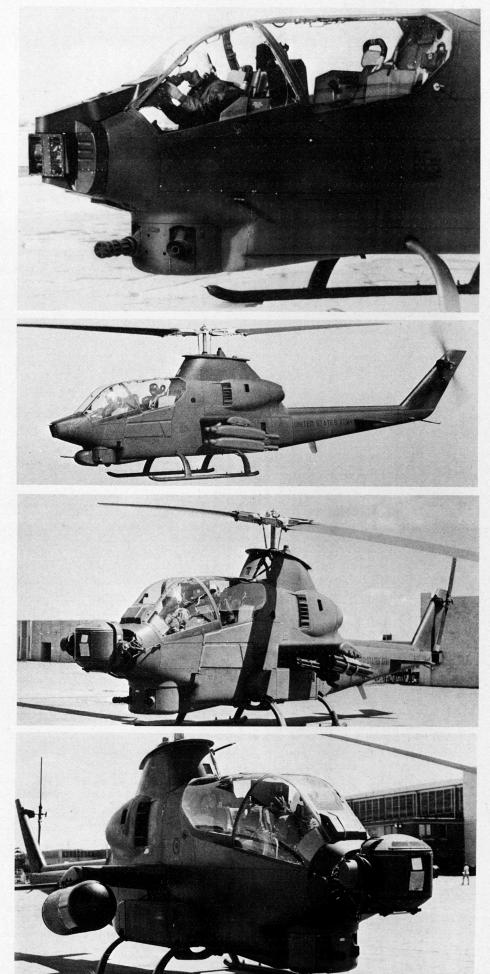
Bild 4 zeigt eine weitere Verwendungsmöglichkeit des gleichen Helikopters mit dem Radome für MTI-Ausrüstung (Moving Target Indicator).
