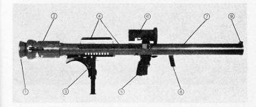
Bild I. Die abschußbereite Panzerfaust. I Antriebsdüse des Starttriebwerks. 2 Geschoßaufnahmekammer. 3 Schulterstütze mit Teleskopzweibein. 4 Tragegriff mit Trageriemen. 5 Griffstück mit Abfeuerungsvorrichtung. 6 Zielfernrohr. 7 Abschußrohr. 8 Handgriff. 9 mechanisches Visier.
