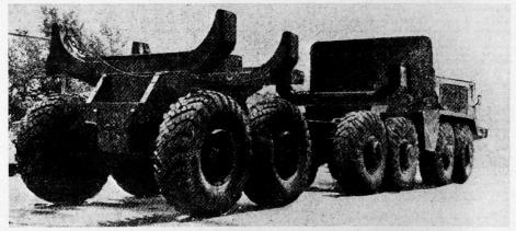
Bild 3. Das Grundfahrzeug der Baureihe MAS  $8\times 8$  mit 520-PS-Dieselmotor, hier mit Anhänger für Rohrtransport «Pletjewos 481».
