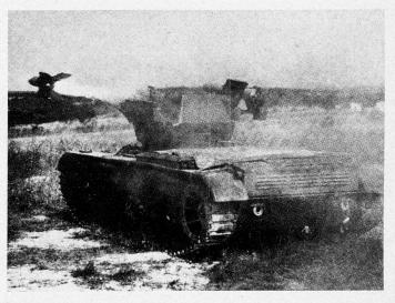
Bild 2. Abschuß einer «Harpon» mit dem neuentwickelten Drehturm NA 2 vom Kleinpanzer «Even».
