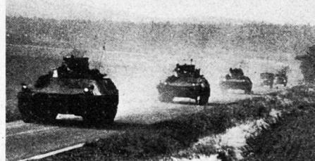
gefahren. Überdies fuhr man 320 km im Gelände, wovon 172 km an einem Tag. Die Fahrt umfaßte auch gefechtsmäßiges Fahren mit Schießübungen. Alle Unterhaltsarbeiten wurden im Rahmen der Fahrt zum Teil feldmäßig durchgeführt. Dabei wurde knapp 200 km vor dem Ziel ein Triebwerk gewechselt; nach 65 Minuten Einbauzeit konnte der Schützenpanzer weiterfahren.       bb
