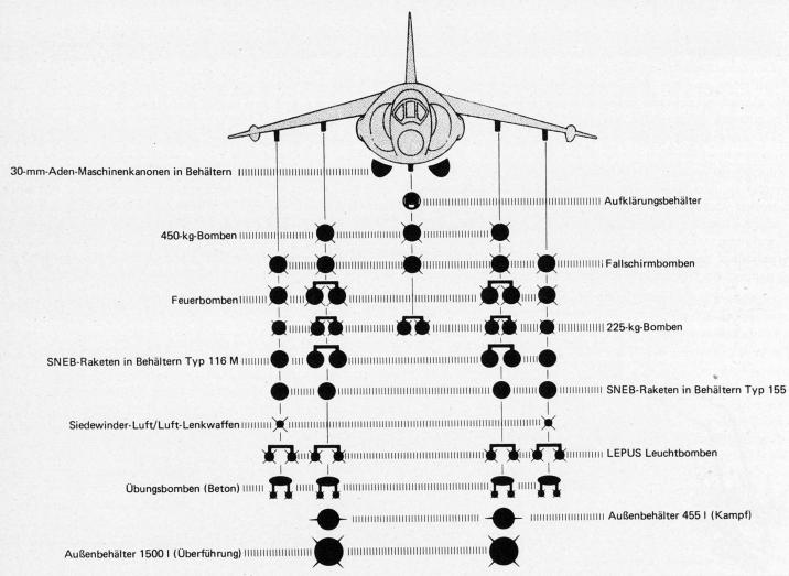
Bild 4. Außenlast-Konfigurationen.
