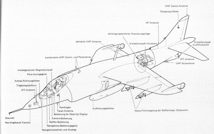
Bild 5. Unterbringung der Ausrüstungen in der «Harrier.
