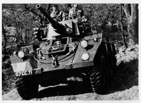
Bild 1. Spähpanzer «Saladin» des Panzeraufklärungsbataillons.
