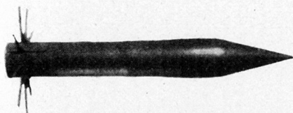
Die un gelenkte Panzerabwehrrakete STRIM mit ausgeklappten Spreizflächen.
