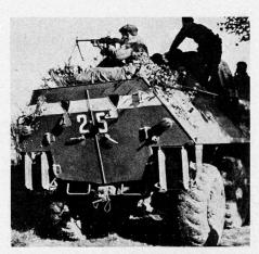
Bild 3. OT64, Heckansicht. Man beachte die Schrauben hinter den Hinterrädern, die Schraubenfedern der Querlenkerauf hängung, die Schießöffnungen und die hohen Klappen über dem Besatzungsraum.
