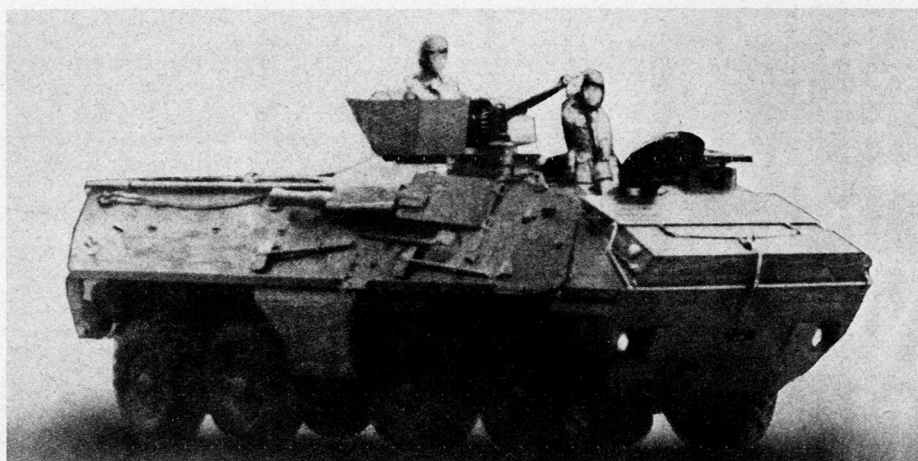
Bild 1. OT 64 mit 12,7-mm-Maschinengewehr im Drehturm.
