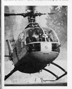
seine zwei Triebwerke, über die der BO 105 als erster Hubschrauber der westlichen Welt in der 2-t-Klasse verfügt, kann er auch ein Optimum an Sicherheit im Allwetter- und Blindflug bieten.
