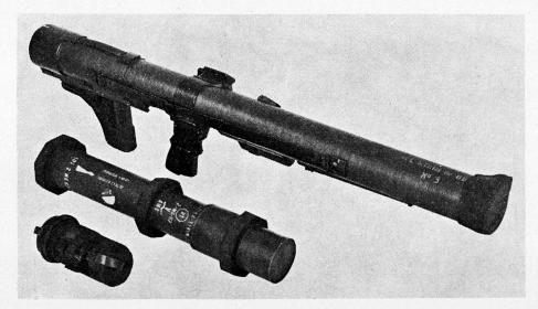
Raketenrohr, Geschoß im Behälter und Richtaufsatz.
