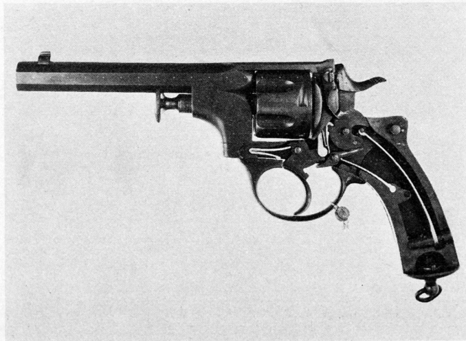
Bild 3. Revolver System R. Schmidt, erstes Modell 1874. Prototyp. Der Lauf kann samt Trommel nach links seitlich ausgeschwenkt und die leeren Hülsen durch den zentralen «Stöbel» entfernt werden.
