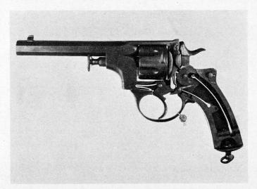
Bild 3. Revolver System R. Schmidt, erstes Modell 1874. Prototyp. Der Lauf kann samt Trommel nach links seitlich ausgeschwenkt und die leeren Hülsen durch den zentralen «Stößel» entfernt werden.
