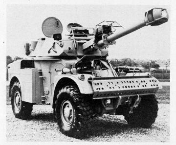
Bild 5. Das Bild stellt die Montage des «Solatron»-Simulators an einem Panzerfahrzeug Panhard AML 90 dar. Zu erkennen sind: der Infrarotprojektor auf dem Geschützrohr, dahinter der Sender-Empfänger und links vor dem geöffneten Deckel einer der Detektorköpfe.
