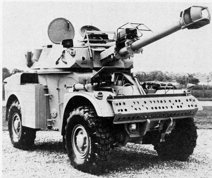
Bild 5. Das Bild stellt die Montage des «Solatron»-Simulators an einem Panzerfahrzeug Panhard AML 90 dar. Zu erkennen sind: der Infrarotprojektor auf dem Geschützrohr, dahinter der Sender-Empfänger und links vor dem geöffneten Deckel einer der Detektorköpfe.
