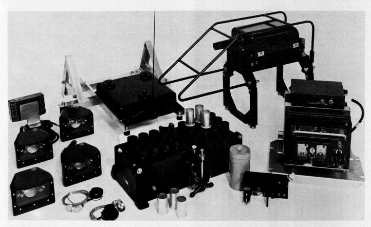
Bild 2. Die Bestandteile des «Solatron»-Simulators: links die Detektorköpfe; Mitte oben der Sender-Empfänger; rechts oben der Projektor mit der Montageeinrichtung; rechts unten der im Innern des Panzers
