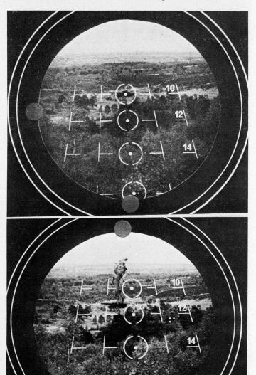
Bild 4. Auf den beiden Photos erkennen wir oben die angerichtete Distanz von 1000 m und die Anzeige des Fehlschusses links-tief, während auf der untern Photo bei der Distanz von 1150 m die Lämpchen das richtige Zielen und der Simulator am Ziel durch den Rauch den Treffer
