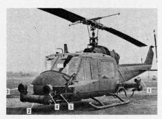
Bild 1. Bell «Iroquois» mit dem INFANT-System. (1) Xenon-Suchlichter, (2) Spezial-Bugdrehturm für INFANT, (3) Nachtsichtgerät, (4) direktes Bildverstärkungsvisier, (5) Faseroptikkabel.
