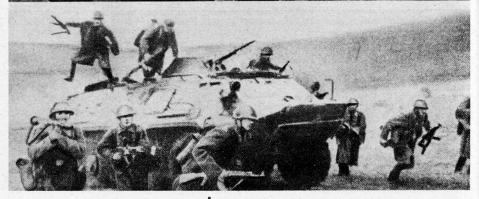
Die Baureihe begann mit der oben offenen Ausführung BTR 60P. Der BTR 60PA wurde etwa 1964 eingeführt, erst 1965 erschien der BTR 60PB mit Drehturm. Diese Ausführung wurde auch an die NVA geliefert, während Rumänien, Ungarn und Bulgarien noch ältere Ausführungen haben.
