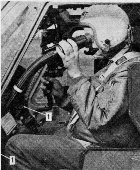
Bild 2. Das direkte Fernsehsystem, kleine Monitore (1) in der Instrumententafel.
