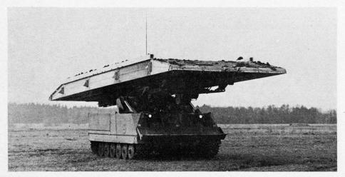
Mit Hilfe des Brückenlegefahrzeugs 941 können Brücken bis zu 7 t Gewicht mit einer Spannweite von 11 bis 15 m gelegt werden, deren Abmessungen so gehalten sind, daß sie Fahrzeuge bis zu 50 t Gewicht tragen. In weniger als 5 Minuten kann eine Brücke aus der Transportposition des Fahrzeuges gelegt werden. Die Brücke kann von beiden Seiten wieder aufgenommen werden. Das Brückenlegen erfolgt hydraulisch; die Bedienung geschieht durch einen oder zwei Mann innerhalb des Fahrzeuges.
