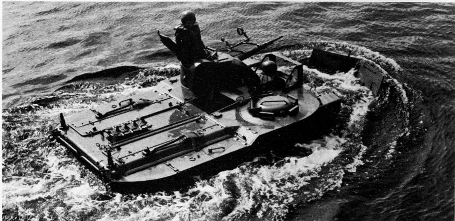
Der Schützenpanzer 302 für das schwedische Heer ist mit einer Maschinenkanone Kaliber 20 mm in einem um 360° drehbaren Turm bewaffnet. Die Waffe kann sowohl gegen Boden- als auch gegen Luftziele verwendet werden.
