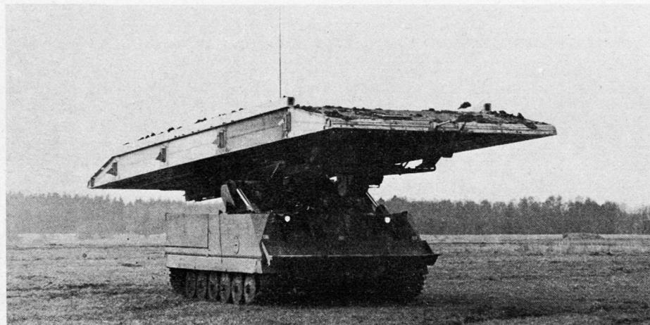
Mit Hilfe des Brückenlegefahrzeugs 941 können Brücken bis zu 7 t Gewicht mit einer Spannweite von 11 bis 15 m gelegt werden, deren Abmessungen so gehalten sind, daß sie Fahrzeuge bis zu 50 t Gewicht tragen. In weniger als 5 Minuten kann eine Brücke aus der Transportposition des Fahrzeugs gelegt werden. Die Brücke kann von beiden Seiten wieder aufgenommen werden. Das Brückenlegen erfolgt hydraulisch; die Bedienung geschieht durch einen oder zwei Mann innerhalb des Fahrzeugs.
