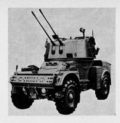
1,8 t schwere Turm kann mit 80°/sec geschwenkt und für Reparaturarbeiten in 15 Minuten abgehoben werden; die beiden 20-mm-Kanonen HSS 820 werden elektrisch oder durch Pedal abgefeuert; Hersteller: Firma «Panhard», Paris.
