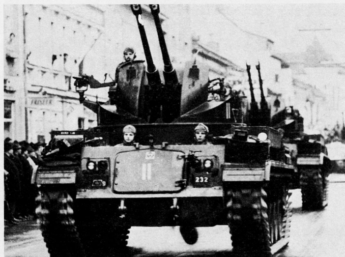
Bild 4. Flabpanzer 40 mm L/60-Zwilling M 42, 2 × 120 Schuß/min, 400 Schuß, 1 Mg, Gewicht 21,5 t, 6 Mann, 507 PS (Benzinmotor), Geschwindigkeit 70 km/h.
