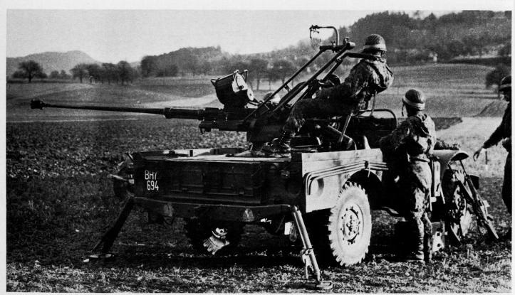
Bild 7. FlAMK 20 mm M 58 auf Dodge-Chassis montiert, 2-cm-Oerlikon-Flak 58.
