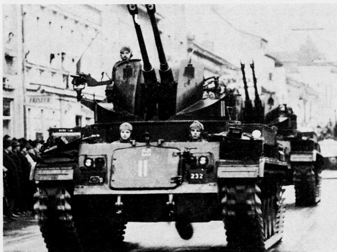
Bild 4. Flabpanzer 40 mm L/60-Zwillings M 42, 2 x 120 Schuß/min, 400 Schuß, 1 Mg, Gewicht 21,5 t, 6 Mann, 507 PS (Benzinmotor), Geschwindigkeit 70 km/h.
