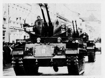
Bild 4. Flabpanzer 40 mm L/60-Zwilling M 42,  $2\times120$  Schuß/min, 400 Schuß, 1 Mg, Gewicht 21,5 t, 6 Mann, 507 PS (Benzinmotor), Geschwindigkeit 70 km/h.
