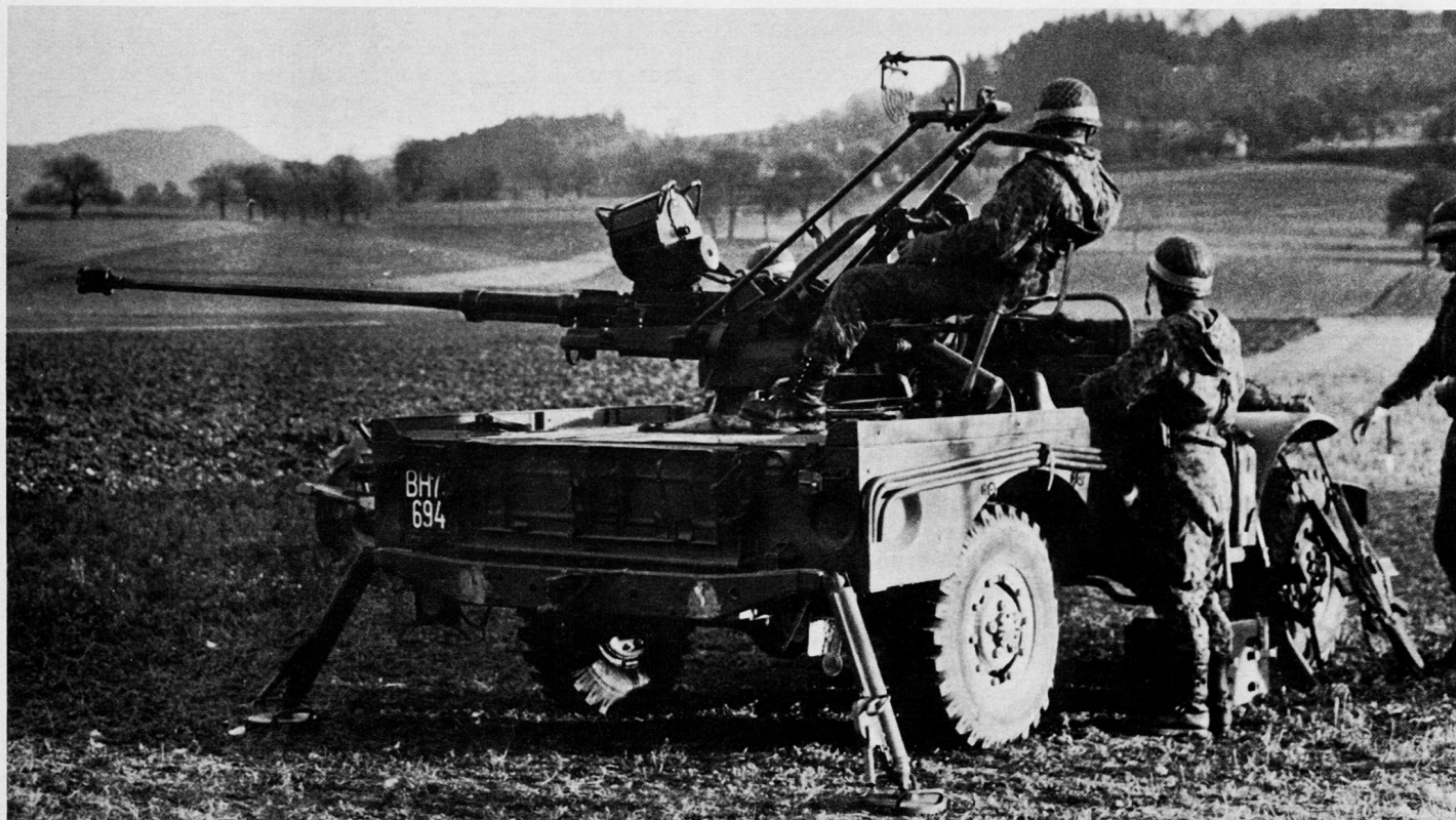
Bild 7. FLAMK 20 mm M 58 auf Dodge-Chassis montiert, 2-cm-Oerlikon-Flak 58.
