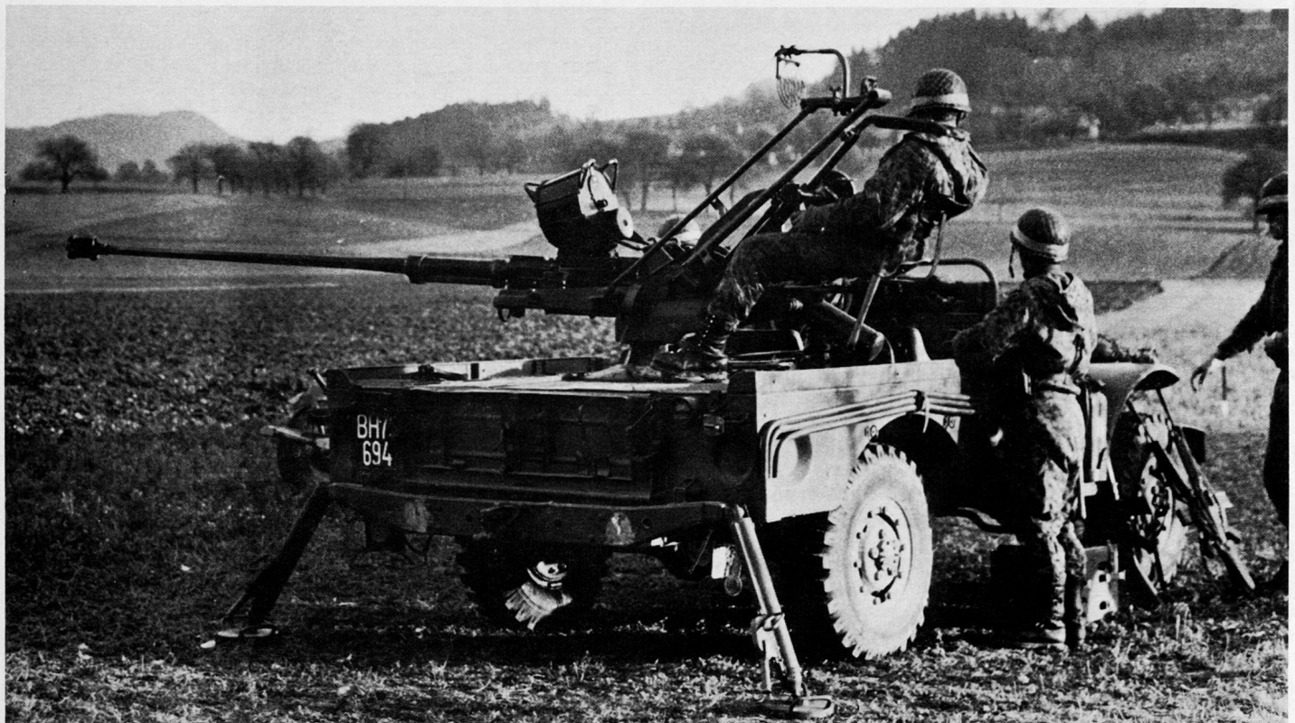
Bild 7. FLAMK 20 mm M 58 auf Dodge-Chassis montiert, 2-cm-Oerlikon-Flak 58.
