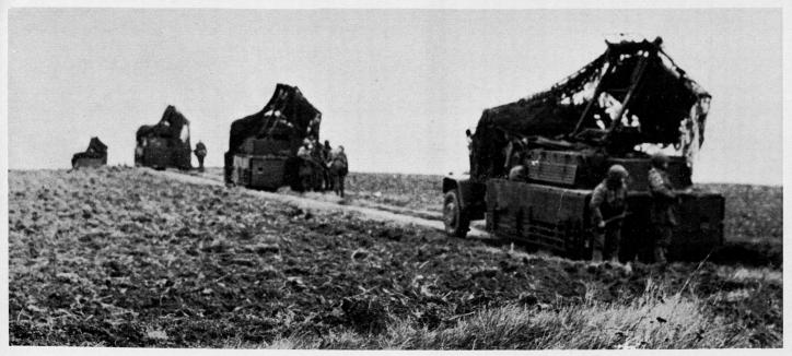
Bild 8. Raketenwerferbatterie mit 4 RM 130 auf Lkw Praga V3S, 5 t, Kaliber 130 mm, Rohrzahl/Werfer 32, Gewicht in Feuerstellung
