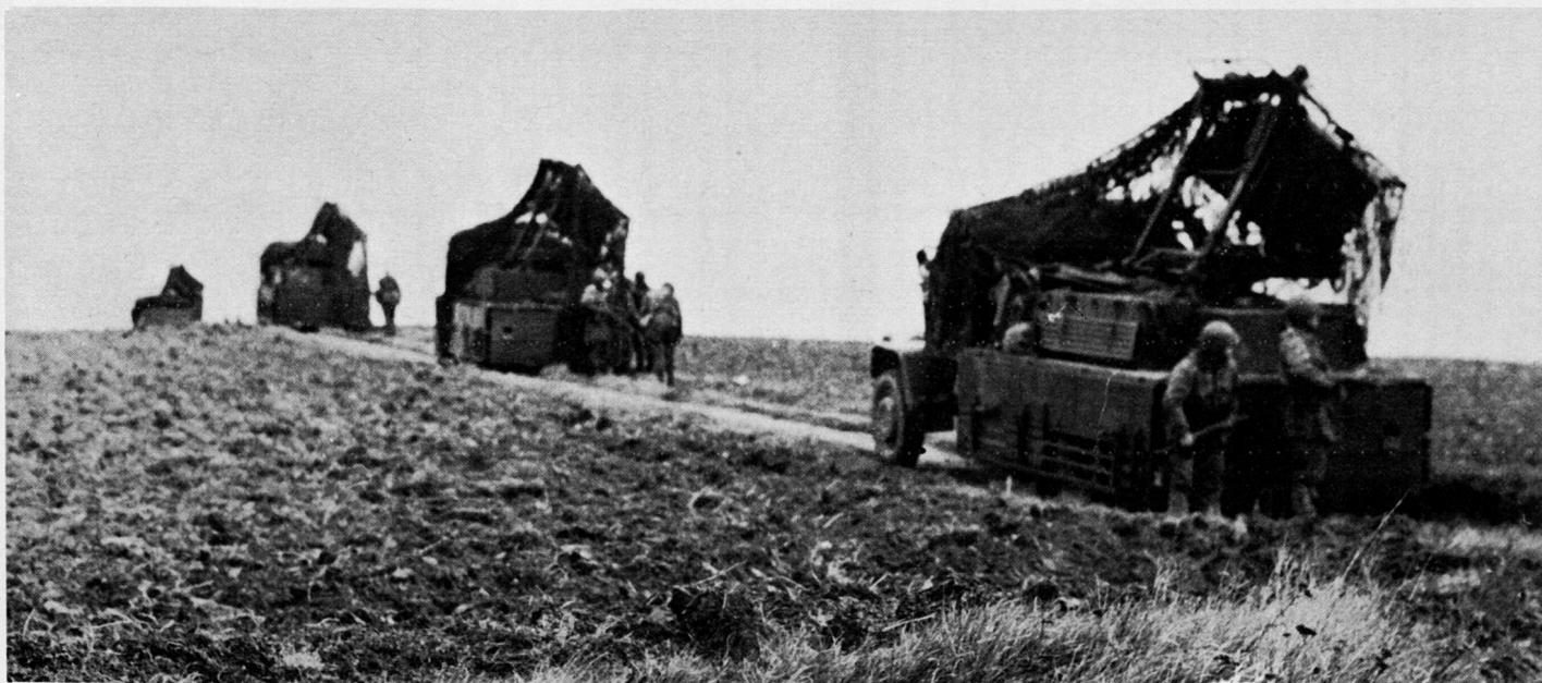
Bild 8. Raketenwerferbatterie mit 4 RM 130 auf Lkw Praga V3S, 12 t, GRAK 26 kg, V_0 410 m/sec, Schußweite 8,2 km, Feuergeschwindigkeit 300 Schuß/min.
