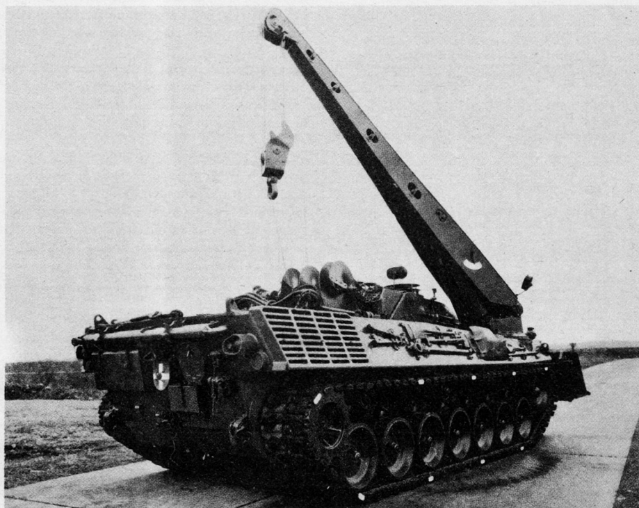
Seitenansicht der Pionierpanzer. Drehkran in Arbeitsstellung.
