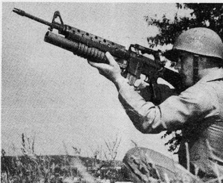
Der neue 40-mm-Granatwerfer am Sturmgewehr M 16 A 1 montiert.
