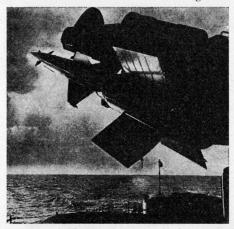
Startearm hängende GOA an Bord eines sowjetischen Überwasser-Flugkörperträgers (vermutlich eines Raketenträgers der «Kresta»-Klasse). Die GOA hat ein verhältnismäßig kleines Gewicht und eine Reichweite von etwa 20 km.
