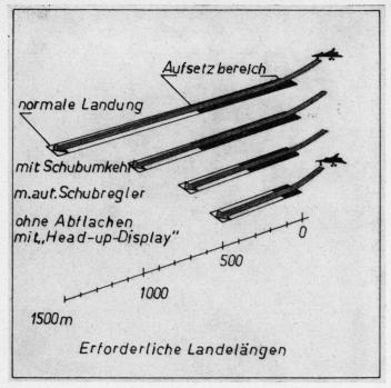
Figur 4. Mögliche Landelängen mit dem «Viggen».
