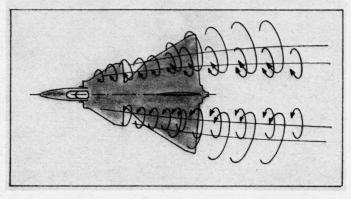
Figur 2. Gegenseitige Unterstützung der beiden Auftriebsflächen beim «Viggen» durch kombinierte Grenzschichtbeeinflussung und Ablenkung der Strömung nach unten.
