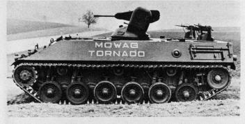
Der von der Firma Mowag entwickelte Kampfschützenpanzer «Tornado».
