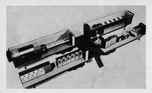
Modell des Combat Service Support System (CS3). Beginnend mit dem Anhänger oben links sind je von links nach rechts zu erkennen: Wartungseinrichtungen und Datenerfassungsgeräte (Kartenlocher und -prüfer). Anhänger oben rechts: Datenübermittlungsgeräte. Anhänger unten links: externe Speicher (Magnetplatten und -bänder). Anhänger unten rechts: zwei Kontrolleinheiten, Schnelldrucker, Lochkartenleser und -stanzer, Zentraleinheit mit Konsolschreibmaschine.
