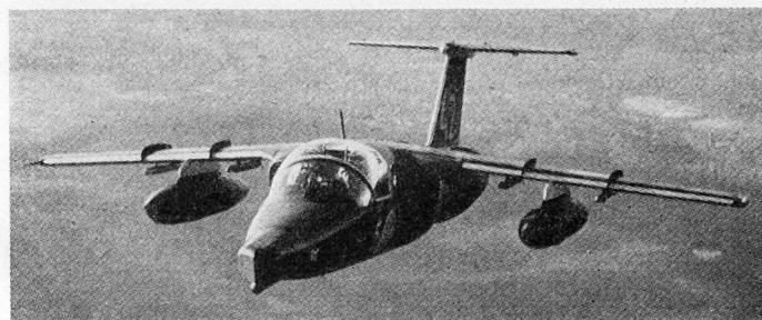
Bild 1. Für die Aufklärung entwickelte Saab die Version SK 60C, deren Bug eine Panoramakamera Fairchild KB 18 enthält. Das abgebildete Flugzeug trägt ferner zwei 30-mm-Kanonen-Behälter unter dem Flügel.
