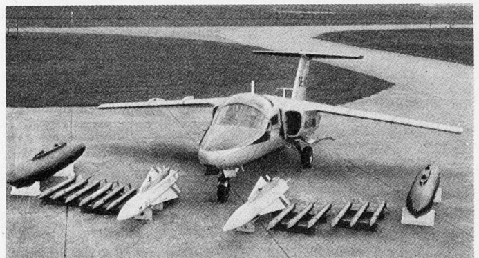
Bild 2. Erkennbar auf dem Bild (von innen nach außen): eine Lenkwaffe Saab 305 mit 135-mm-Raketen und einen 30-mm-Kanonen-Behälter.
