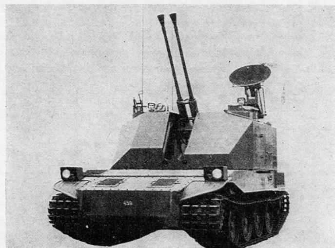
Bild 7. VEA 40 x 62 (Schweden). 40-mm-Zwillingsgeschütz Bofors L70; Rundsuch-, Sektorsuch- und Entfernungmeßprogramm.
