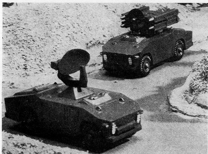
Bild 11. Projekt «Crotale» (Frankreich). Geteiltes System: Der Raketen-trägerpanzer für vier Lenkraketen verfügt über ein Zielverfolgungsradar, während ein Feuerleitpanzer ein weitreichendes Rundsuchgerät trägt.
