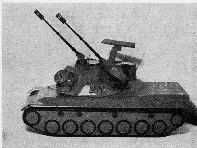
Bilder 5 und 6. «Leopard» (BRD). Drehturm mit ähnlichen Waffen wie AMX DCA 30; vorläufig noch Erprobung von zwei Prototypen: «Oerlikon» mit 35-mm-Zwillingsgeschütz, MTI-Rundsuch- und Puls-F Feuerleitradar, «Rheinmetall» mit zusätzlichem Feuerleitradar vor der Turmfront und Ausrüstung zur Freund/Feind-Erkennung (IFF).
