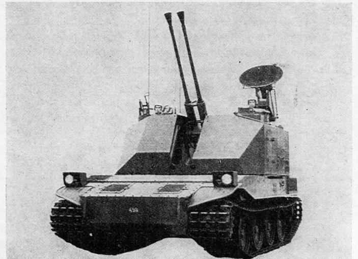
Bild 7. VEAk 40 x 62 (Schweden). 40-mm-Zwillingsgeschütz Bofors L70; Rundsuch-, Sektorsuch- und Entfernungsmessprogramm.
