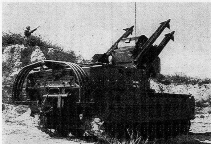
Bild 12. Prototyp XM 548 «Chaparral» (USA). Amerikanische Notlösung mit der bewährten Rakete «Sidewinder», die einen aktiven Infrarotsuchkopf hat; Fahrgestell des Schützenpanzers M 113; Abschub-turm ungepanzert.
