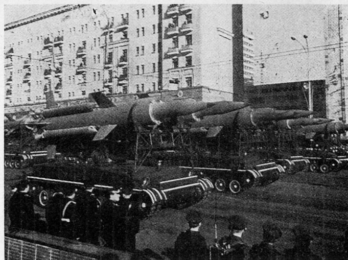
Bild 16. «Ganef» (UdSSR). Schwerer Werfer auf Sonderfahrgestell zum Einsatz auf größere Entfernungen; zwei Staustrahlflugkörper: sehr verwundbar, da für die Flugkörper kein Panzerschutz vorhanden.
