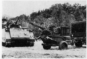
Bild 2. XM 163 mit 20-mm-Flabkanone M61 «Vulcan» (USA). Amerikanische Notlösung mit der bekannten «Gatling»-Revolverkanone mit sechs Rohren, kleinem Zielverfolgungsradar. Die Rohre werden durch einen Elektromotor zum schnellen Rotieren gebracht, so daß das nächste Rohr schon abgefeuert werden kann, bevor der Ausziehvorgang am vorhergehenden Verschluß beendet ist.
