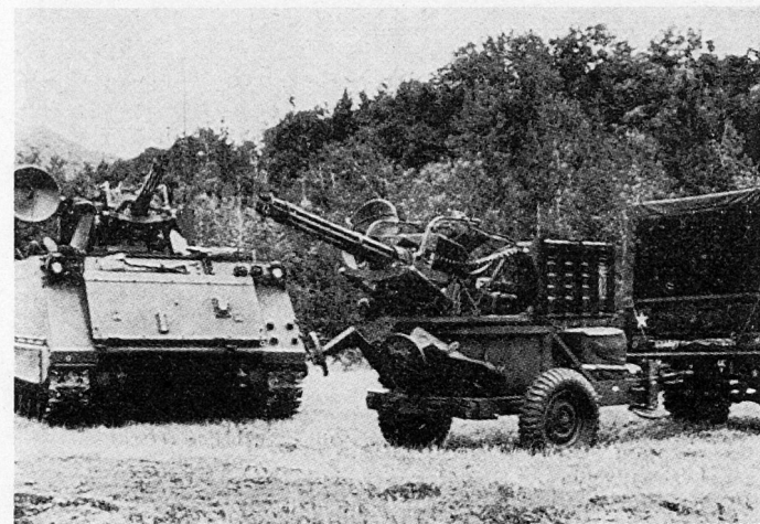
Bild 2. XM 163 mit 20-mm-Flabkanone M61 «Vulcan» (USA). Amerikanische Notlösung mit der bekannten «Gatling»-Revolverkanone mit sechs Rohren, kleinem Zielverfolgungsradar. Die Rohre werden durch einen Elektromotor zum schnellen Rotieren gebracht, so daß das nächste Rohr schon abgefeuert werden kann, bevor der Ausziehvorgang am vorhergehenden Verschuß beendet ist.
