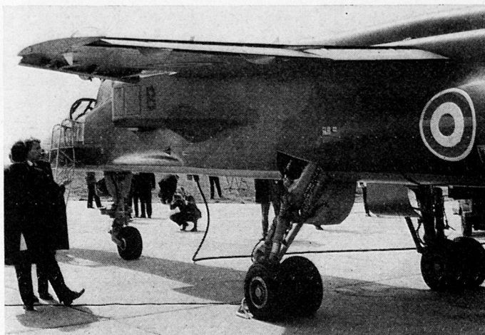
Bild 3. Der sehr schlanke Flügel des «Jaguar» mit seinen Hochauftriebs- hilfen. Gesteuert wird mittels Störklappen, verstellbarer Höhenflosse und Seitensteuers.
