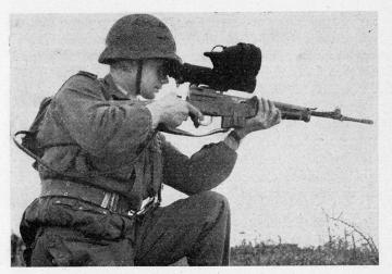
Auf das Gewehr angepaßter Infrarotprojektor mit Zielfernrohr.
