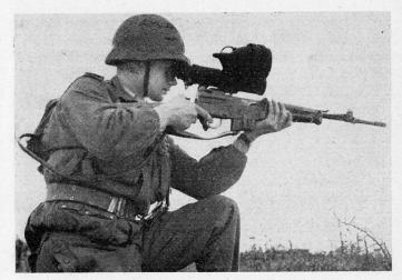
Auf das Gewehr angepaßter Infrarotprojektor mit Zielfernrohr.
