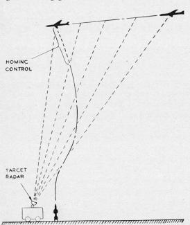
Bild 4. Zieldeckungs- und automatisches Steuerungssystem.
