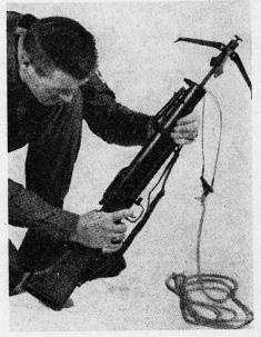
bestehend aus dem Anker, einer 120 m langen Nylonleine mit einer Belastungsfähigkeit von 136 kg und 6 Raketentreibsätzen, beträgt etwa 9 kg. Der Raketentreibsatz für den Wurfanker kann sowohl aus dem 40-mm-Gewehrgranatgerät des Gewehrs M 16 A 1 als auch aus dem Granatwurfgerät M 79 verschossen werden. Der Wurfanker hat ein Gewicht von 2 kg.
