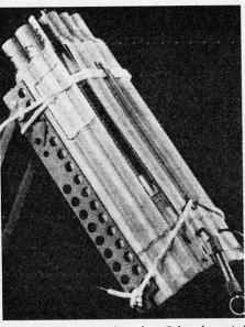
weite von 600 m. Während 30 Sekunden wird ein Gebiet von 400 m Durchmesser pro Körper ausgeleuchtet, so daß eine Gefechtsfeldbeleuchtung von etwa 6 Minuten möglich ist. Das gesamte Gerät wiegt 5,9 kg und ist hauptsächlich aus Kunststoff hergestellt.
