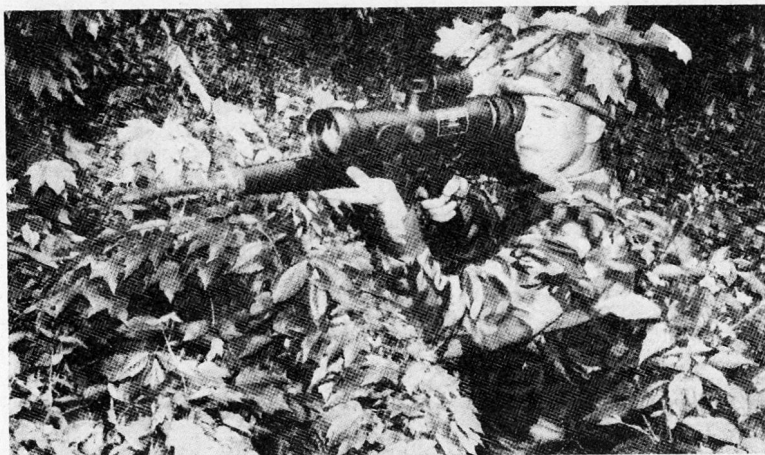
Das «Starlight Scope AN/PVS 2» läßt bei Nacht Soldat und Panzer vor bewaldetem Hintergrund deutlich erkennen.
