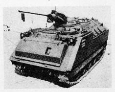
Weiterentwicklung aus dem Grundmodell M 113; die Seiten wurden mit einer Schottpanzerung versehen, die Wand des Kampfraumes ist abgeschrägt und mit drei Schießöffnungen und Beobachtungsblöcken versehen, die Kommandantenkuppel mit einer 20-mm-Kanone HS 820 in Außenlafette bestückt. Die Arbeit stellt einen Schritt vorwärts in Richtung auf ein echtes Kampffahrzeug dar. («Soldat und Technik» Nr. 8/1968)
