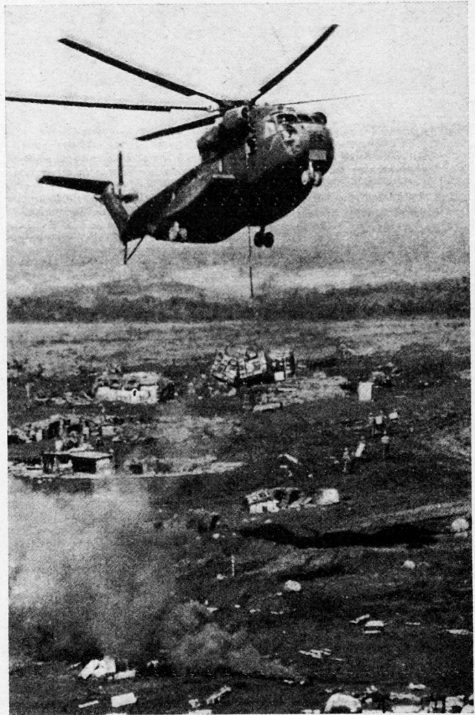
CH-53 A im Versorgungseinsatz bei Con Thien (Südvietnam). An der Lastenschlinge Munition und Verpflegung, die ohne Bodenberührung des Hubschraubers im Schwebeflug abgesetzt werden kann. Dieses Verfahren wird dort angewendet, wo aus landschaftlichen oder taktischen Gründen eine Landung mit längerer Be- und Entladezeit nicht angebracht ist.
