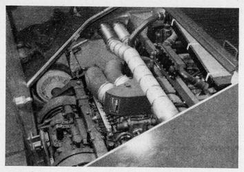
Bild 10. Antriebsgruppe eingebaut mit geöffneter Wartungsklappe.
