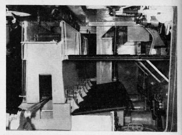
Bild 4. Aufgeklappte Liegeeinrichtung für Verwundetentransport.
