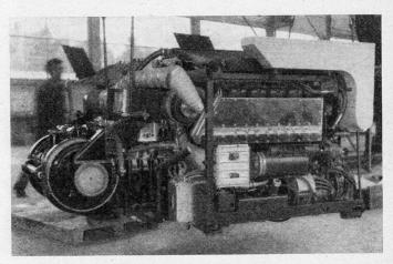
Bild 9. Antriebsgruppe vollständig in Blockbauweise.
